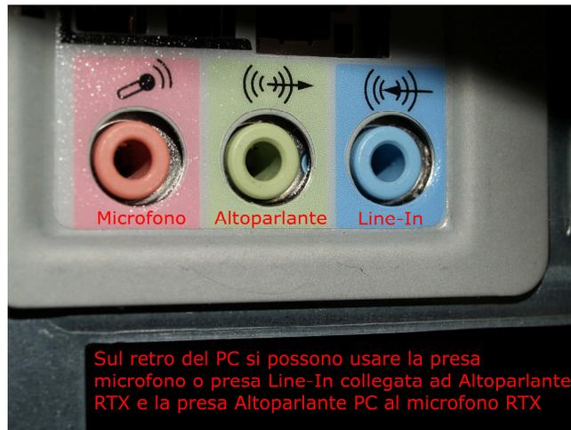
Collegare il cavo microfonico al ricetrasmittitore (RTX), vi e' la possibilita' in alcuni RTX di utilizzare la presa digitale (in questo caso vi dovete far preparare un cavo cablato per la presa digitale)
