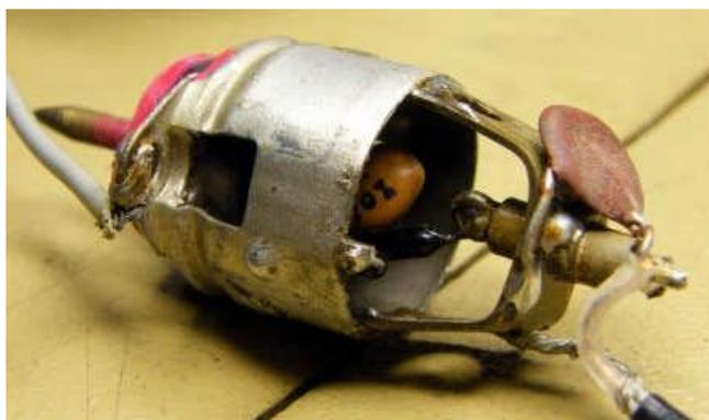
Una versione più moderna ha un puntalino di ricambio Tektronix infilato in un tubetto di ottone da 6mm. Ho usato diodi Schottky e condensatori super miniatura, e in effetti il coccodrillone stona un po'...
