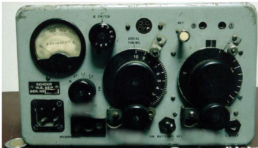
Revisionando il circuito ho constatato che molte resistenze erano di valore alterato, alcune interrotte, e pressoché tutti i condensatori a carta erano in perdita o in corto. La loro sostituzione è stata necessaria. Inoltre è stato necessario re-incollare i nuclei delle bobine in polvere di ferro ai supporti a vite in bakelite, per riuscire a tarare.
