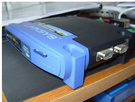
**Siccome queste porte serali sono a livello CMOS 3,3V, è necessario l'uso di un convertitore di livello a V24. A tale scopo ho scelti l' ST3232:**
