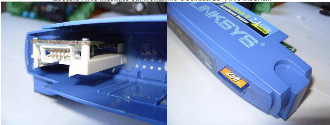
L'interfacciamento della scheda SD-MMC avviene tramite le GPIO presenti sulla scheda del processore BCM5352, sfruttando le linee GPIO usate dai LED e dal tasto SETUP.
