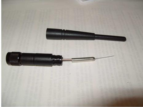
Il vantaggio di questa antenna è che ha un pezzo di cavetto coassiale in TEFLON completo del connettore TNC-R con uno snodo (comodissimo se si usano cavi coassiali molto rigidi).
